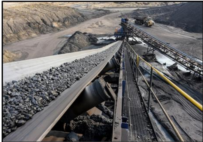
Imagen N° 4. Modelo de Cinta transportadora acanalada. Fuente: FREEPIK. https://www.freepik.es/fotos-premium/cinta-transportadora-procesamiento-mineral-carbon_43052208.htm .
