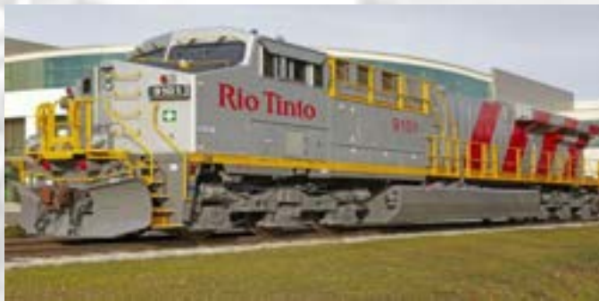
Figura N° 3. Locomotora GE AC4400CW de Río Tinto. Fuente: Redes social de la empresa.
