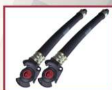
Manguera de aire wabco987102/automático Ubicación: vagones
