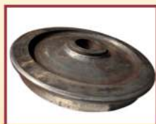
Rueda de 43" para ser utilizada en locomotoras Ubicación: locomotoras marca EMD
