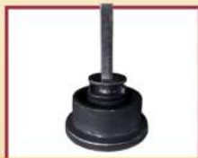
Rueda y buje de la cadena metálica / Ubicación: Planta de Briquetas
