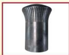
Punta de quemador Ubicación: reformadores
