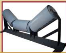
Estación de rodillo de carga / Ubicación: Sistema de transporte de mineral y productos. Minería PMH - Pta. Pellas y Briquetas
